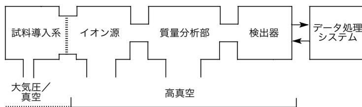
図 1.1：質量分析計の概念図。種々の試料導入系がイオン源に取り付けられる。試料を大気圧から高真空のイオン源や質量分析部に輸送するのに、真空ロックが使われる（5 章 3 参照）。
